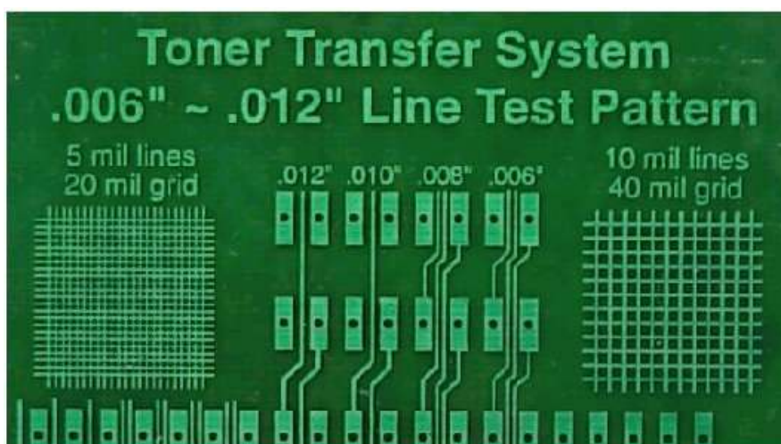
Fig. 9 Structură de test realizată prin metoda transferului termic
